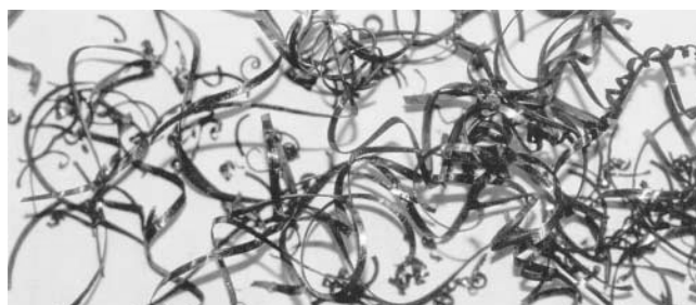
Phôi khi khoan trên thanh ray đã nhiệt luyện
